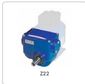
Durch die Kombination von zwei Schneckensätzen in einem kompakten Gehäuse ergeben sich große Übersetzungsmög-lichkeiten.
